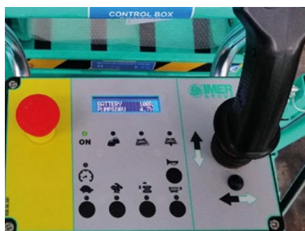
Panou de control detasabil cu butoane capacitive: simplitate si siguranta in utilizare
